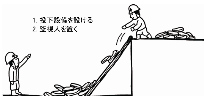
図2-8 投下設備の設置
