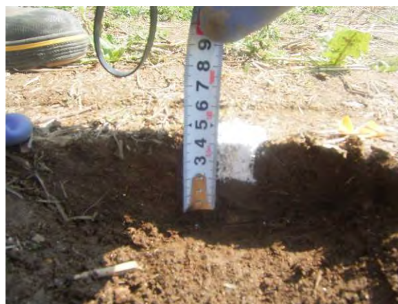
写真 10 石灰のマーキング柱による沈下量の確認 (山木屋)
