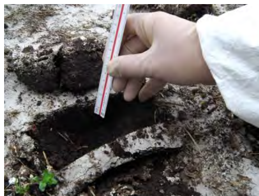
写真 15 エコロック 1000（マグネシウム系/長泥）
