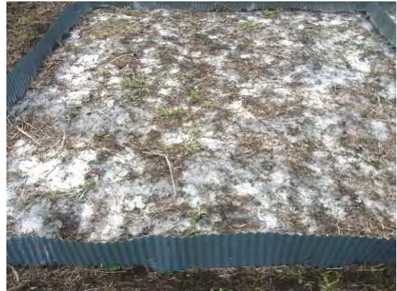
写真 18 固化剤散布試験状況
