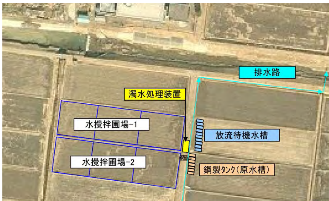
図 13 水による土壌攪拌・除去の機器配置の例
