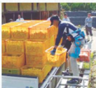
上) 一輪車を押してみかん畑の斜面を登るときも、股関節をアシストしてくれるので、体にかかる負担が軽減される 中) アシストスーツを装着したままで車の運転もできる 下) 収穫したみかんをトラックの荷台に積みよような、中腰での作業でも疲れないと、農家の方にも好評
