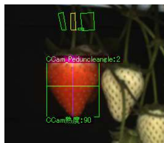
図4 果柄切断位置の検出と採果機構
