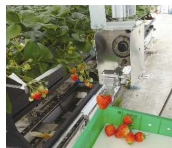
図4 果柄切断位置の検出と採果機構
