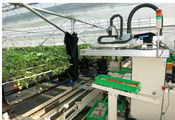
図1 定置型イチゴ収穫ロボットと循環式移動栽培装置
