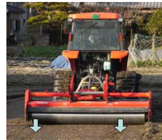
[図4 小型スキ装着で轍を解消]
