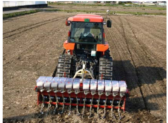
鎮圧・溝切りした整地ほ場での不耕起V溝直播作業
