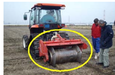
[図5 自作の駆動式溝切機]
