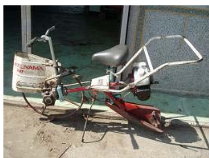
自転車廃品利用で、乗用に改良した水田溝切機
