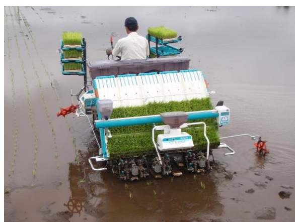
写真1 田植え・施肥・農薬散布を同時処理
