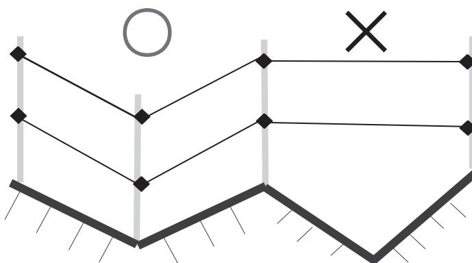
図 13 段差がある場合（斜面に沿って設置）
