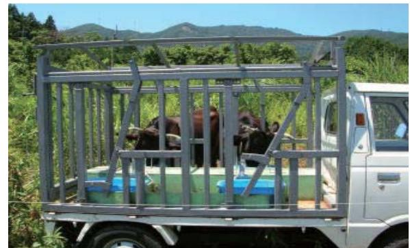
図8 車載式運動スタンチョン
