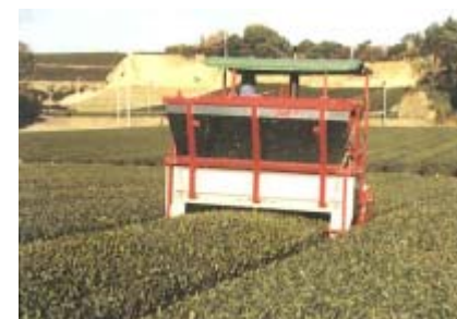
乗用型堆肥散布機による散布作業
