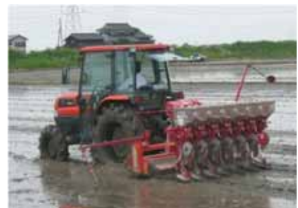
図3 打込み式代かき同時点播機
