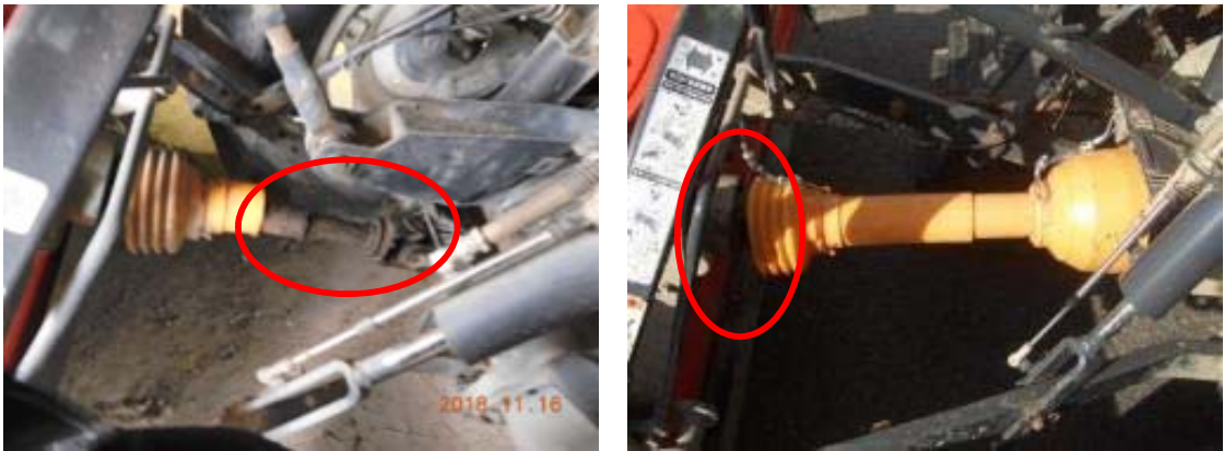
PTO軸のカバーが外れ、回転部が露出した状態に
