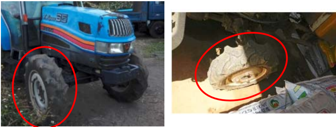
タイヤのラグの摩耗、空気圧の不足
