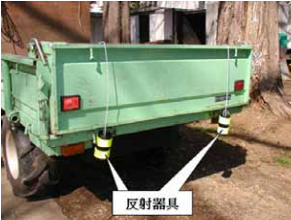
空き缶に反射シールを巻き、針金で機械に後からぶらさげるもの
