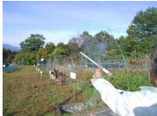
サル追い払いに使うロケット花火発射装置：ひとし君2号の試射（猿害防止展示コーナー）
