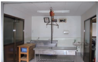
懸ちょう設備を備えた 解体処理室の例
