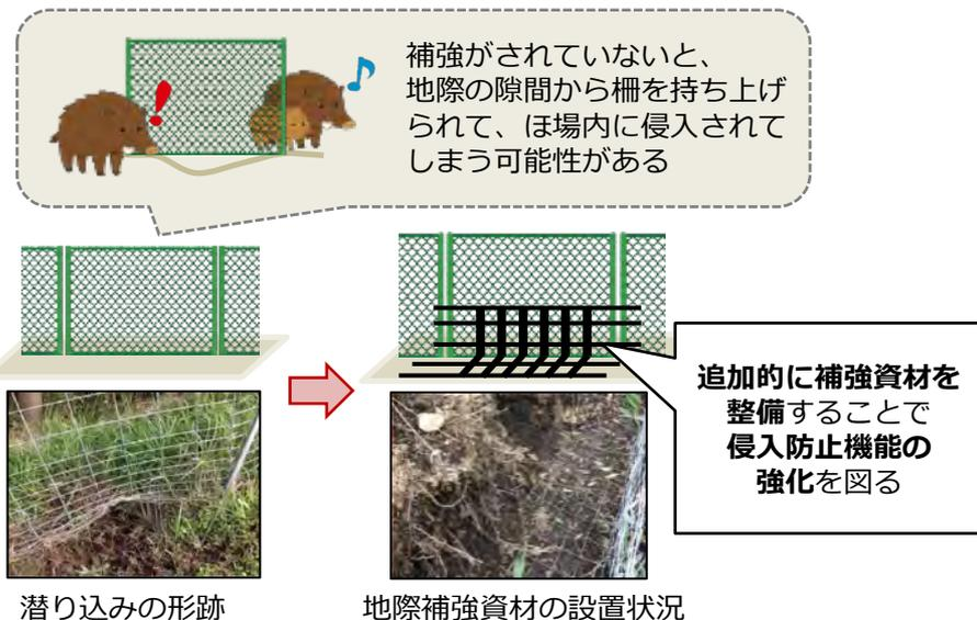
補強がされていないと、地際の隙間から柵を持ち上げられて、ほ場内に侵入されてしまう可能性がある
