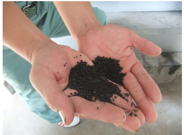
写真 2-11 衛生センター 乾燥汚泥
