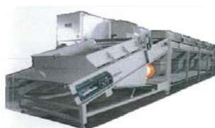
効率的な抹茶生産のための 新型てん茶炉（茶葉処理加工施設）
