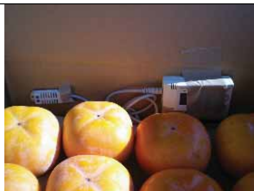
自記温度計設置状態（15℃） （平成 22 年 11 月 21 日撮影）
