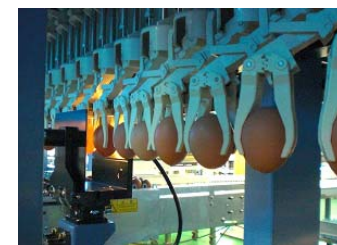
異常卵検査装置による品質確認
