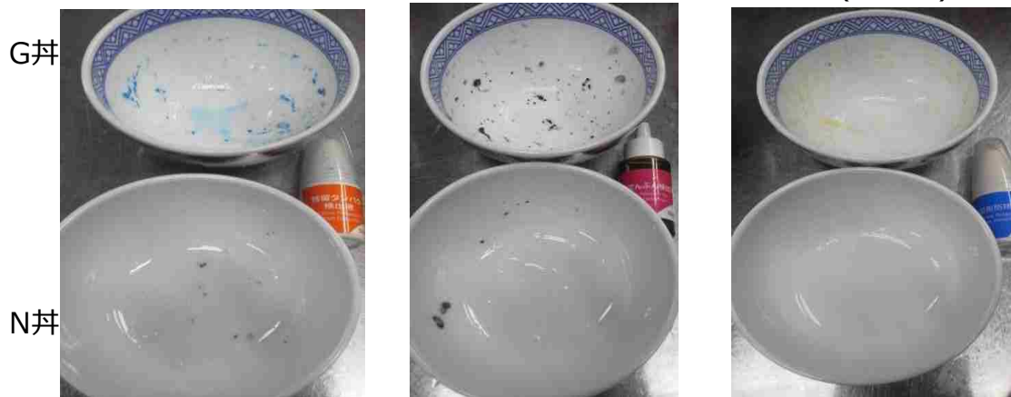
【洗浄機による洗浄】 たんぱく・でんぷん・脂肪の残留状況(呈色度)
