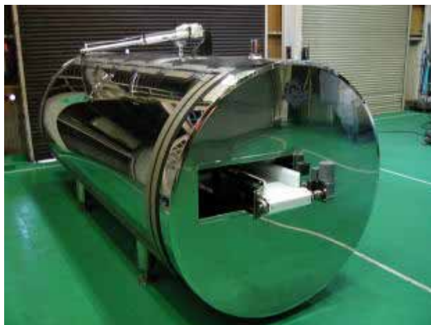
図表 インバーター冷凍機搭載式トンネルフリーザー
