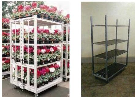
(写真左) フル台車 : W1055mm×D1285mm×H2068mm
