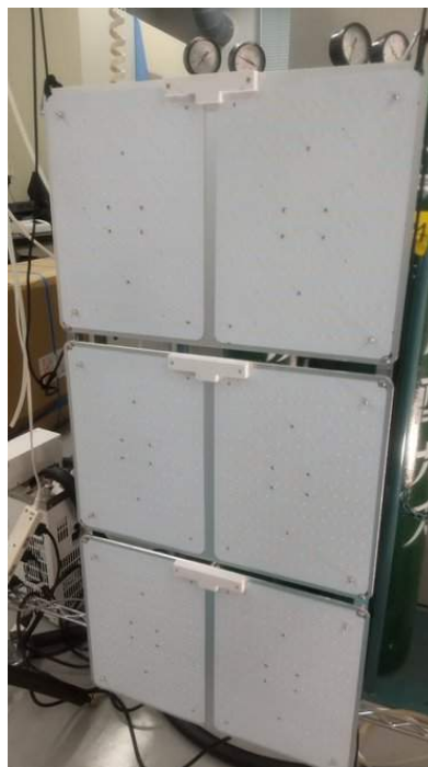
図3.3.4.3-4 ④のLEDを利用した平板型アクリル培養槽用の光源
