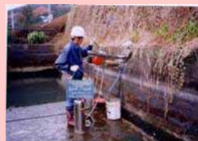
機能診断 (コア採取による強度測定)
