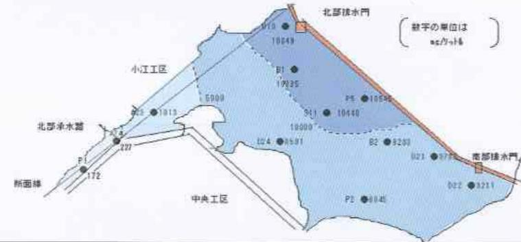
調整池の主要な断面における塩化物イオン濃度の鉛直分布図（5月15日）
