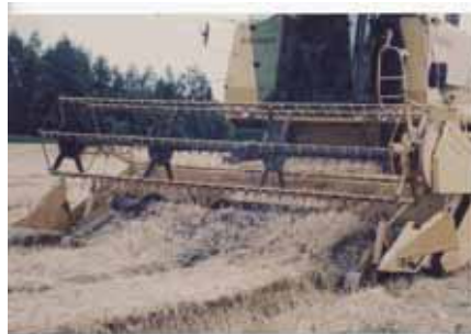
写真2 2日程度の天日乾燥をした後、ピックアップ装置を装着したコンバインで拾い上げ収穫する。
