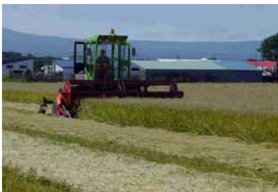
写真1 晴天を見計らってヘイバイン(大型刈り倒し機)で一斉に刈り倒しを行い天日乾燥する。
