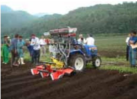
東北農業研究センターで開発された「うね立て同時部分施用機」
