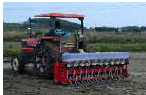
図3 不耕起V溝直播機
