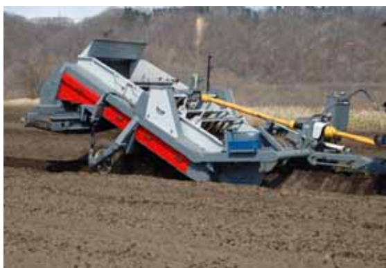
ばれいしょソイルコンディショニング (国産セパレータによる石等の除去及び砕土)
