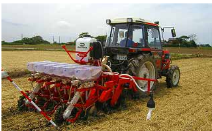
図2 ディスク駆動式不耕起汎用播種機
