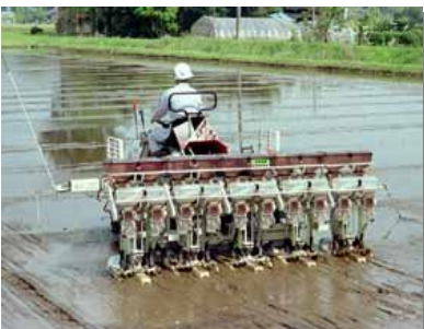
図1 高精度湛水直播機
