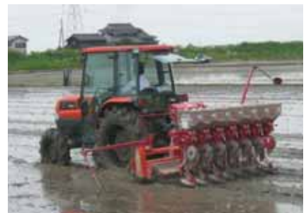
図3 打込み式代かき同時点播機
