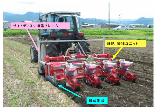
小明渠作溝同時浅耕播種装置
