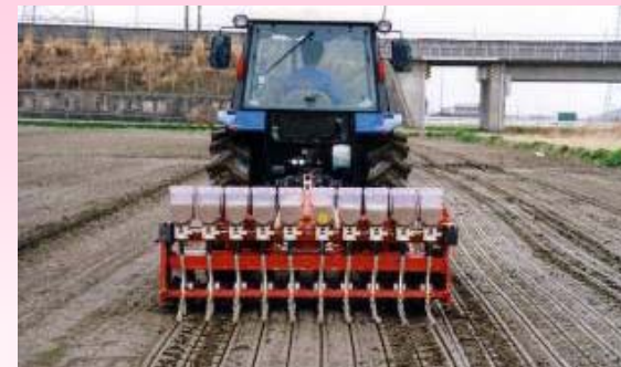
↑ 不耕起V溝播種機(幅2cm、深さ5cmのV溝に播種し、播種深度が深いため、鳥害や倒伏を軽減できる)
