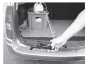
人工授精師の車両に装着した自動車用薬液噴射装置と手持ち消毒ノズル（豊頃町）
