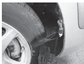
人工授精師の車両に装着した自動車用薬液噴射装置と手持ち消毒ノズル（豊頃町）
