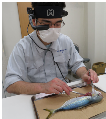
ウェアブルカメラを活用し 検査員が検査する魚を遠隔で確認する様子
