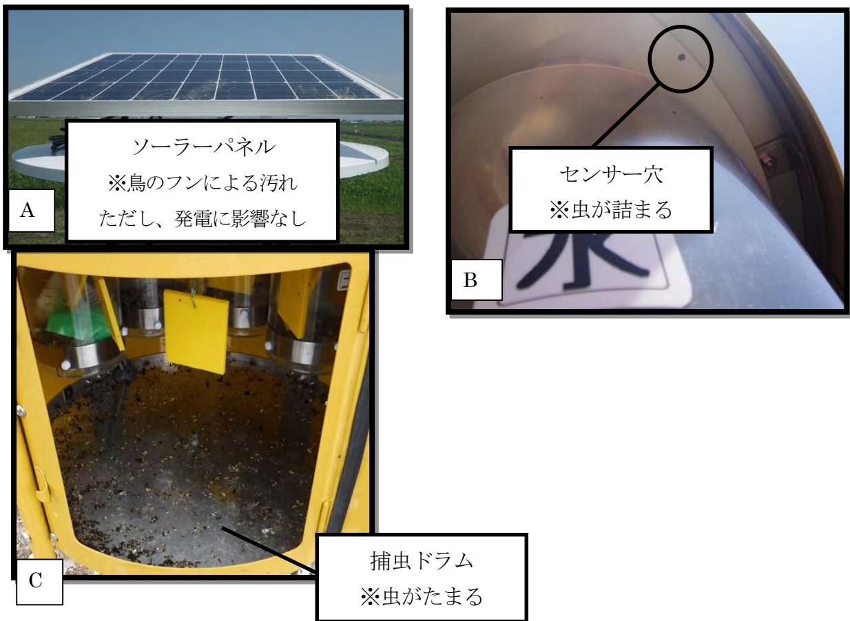
図3 独立電源型予察灯稼働における各種問題点 A;最上部ソーラーパネル、B;内部センサー穴、C ; 捕虫ドラムの内部
