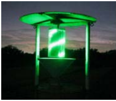
図2 乾式予察灯 (左: LED 光源、右: 白熱電球)
