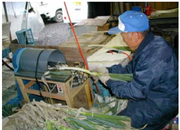
導入皮剥機による皮剥き作業
