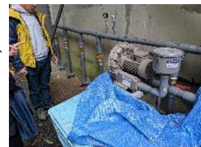
エアレーション設備（右写真）を追加し、堆肥原料の床下から送風（上写真）
