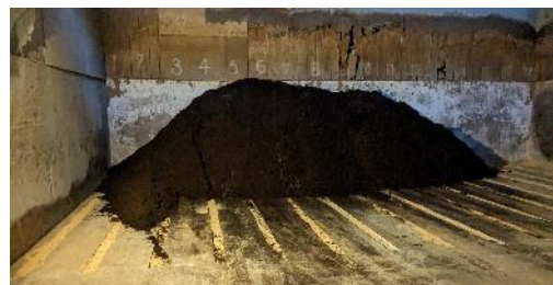
エアレーション設備（右写真）を追加し、堆肥原料の床下から送風（上写真）
