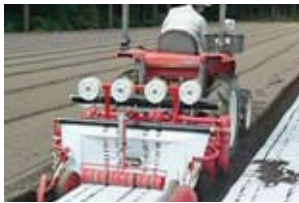
白黒ダブルマルチの敷設
