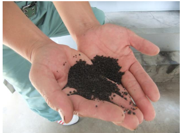
写真 2-11 衛生センター 乾燥汚泥
