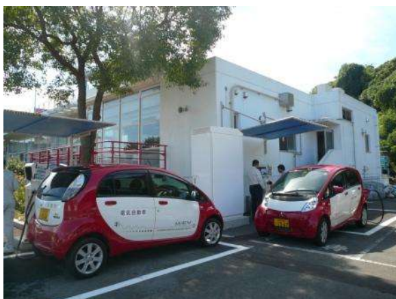
写真8 急速充電器でEVを充電 ＝富江温泉センターにて
