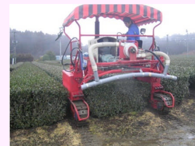
独自開発した除灰装置による除灰作業
