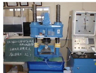
採取コアによる 圧縮強度試験
