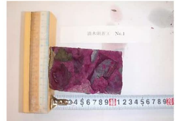
採取コアによる 中性化試験
