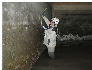
コンクリートテスタ による強度推定状況
