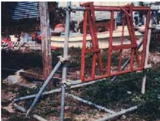
写真8 移動式セルフフロックスタンション
