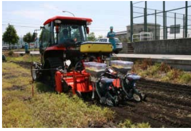
高畝立て深層施肥播種機 正転・逆転ロータリに深層施肥を搭載した播種機 2条播、作業幅 1.5m
