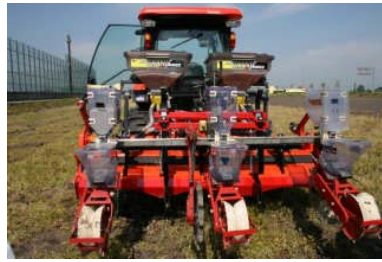
小畝立て深層施肥播種機 畝整形板を付けた代かきロータリに深層施肥を搭載した播種機 3条播、作業幅 2.25m
