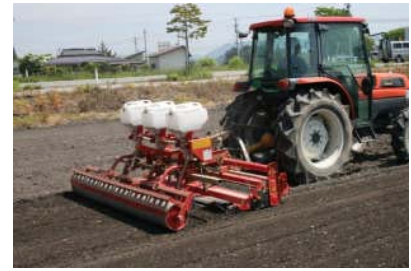
慣行の整地播種機 慣行作業で使用している播種機 3条播種、作業幅 2.1m
