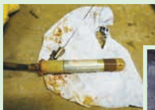
【水位計センサー（交換前）】
