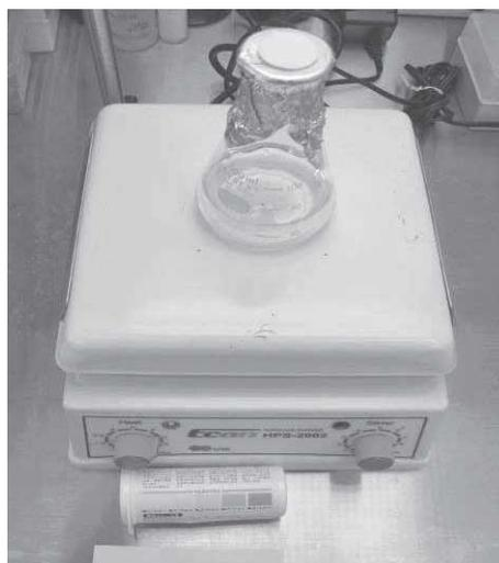
写真4 脂肪酸化度試験
