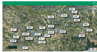
情報共有している揚水機場の運転状況画面（点灯色で運転状況が一目で確認できる） 青：ポンプ運転正常、赤：ポンプ運転停止、紫：通信異常・停電異常
