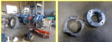
30年使ったトラクターの絶版部品を製作、引き続き使えるように（依頼元：群馬県太田市農協）
