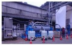
農場で牛・豚の死体を破砕・加熱処理する装置
