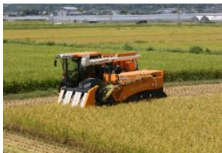
【収量計測機能付きコンバイン】 （岡山県岡山市）
